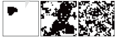
磁石の性質のコンピューター・シミュレーション (イジングモデル) (左:低温、中:中温、右:高温)
