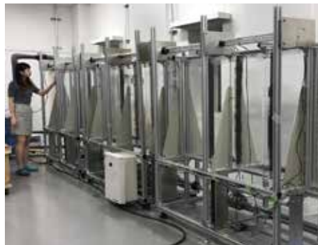
「乱流屏風」(水の流れの相転移の実験装置) 所蔵: 東京大学
