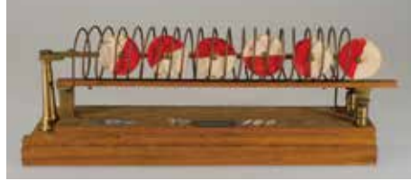
磁石の性質を説明する戦前の教材(分子磁石模型) 所蔵: 国立科学博物館
